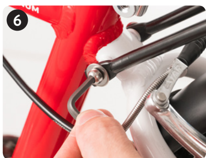
Beidseitig c + d mit B befestigen Use B to install c + d on both sides
