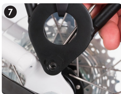
Bohrungen und Schutzblechhalterung ausrichten Align both fender and rack holes to the frame hole
