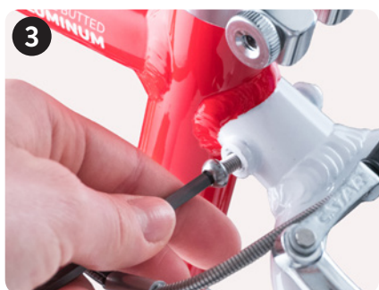
Beidseitig Schrauben lösen mit B Remove screws with B on both sides
