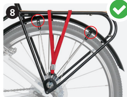
Positionierung der Schutzblechhalterung beachten! Make sure that the fender is mounted correctly!
