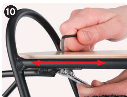
Für Feinadjustierung Schraube lösen mit A + C Minor bolt adjustment with A + C
